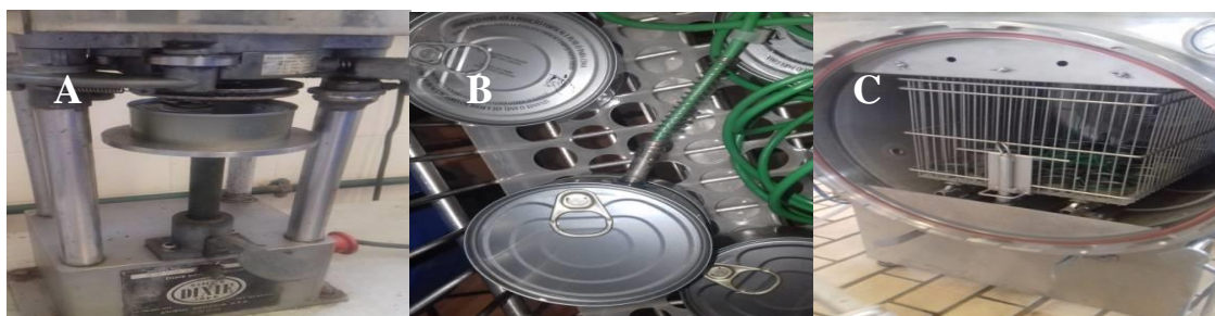
Figura 7. (A) Fechamento (recravação) das latas; (B) Lata no interior da autoclave com o termopar; (C) Autoclave utilizada no tratamento térmico da formulação proposta.
