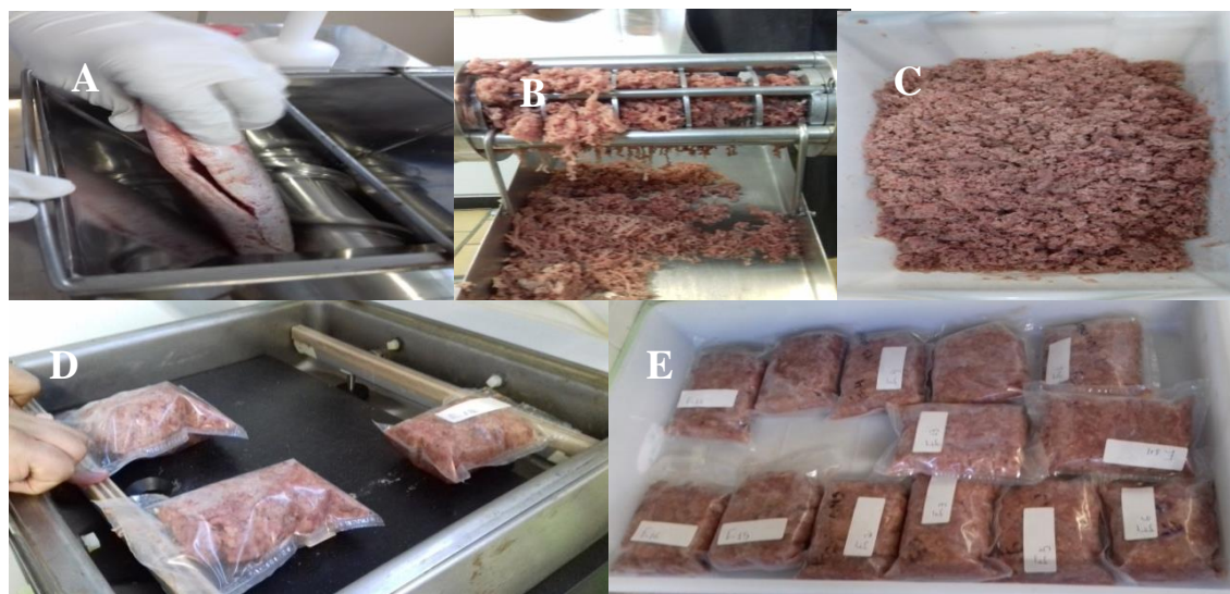
Figura 3. (A) Pescada bicuda descabeçada e eviscerada passando pela despulpadeira; (B) Produção da CMS; (C) CMS; (D) Fechamento à vácuo das embalagens ; (E) CMS embaladas e identificadas.
