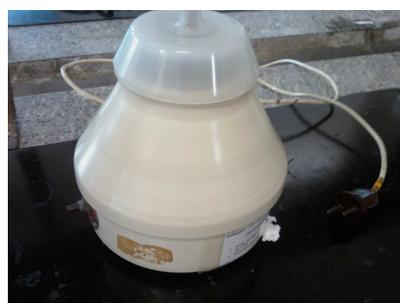
**Figura 7.** Agitador de tubo AP56-Phoenix
