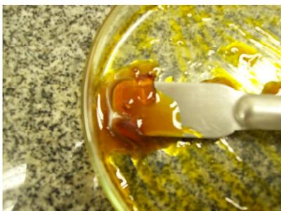
**FIGURA 5.9:** Óleo obtido da torta por extração etanólica.
