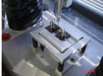
Figura 8. Análise de perfuração com o Texturômetro TA.TX2 Stable Micro Systems.
