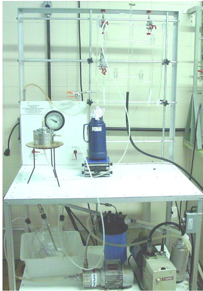
Figura 7 – Sistema de pervaporação utilizado nos experimentos.
