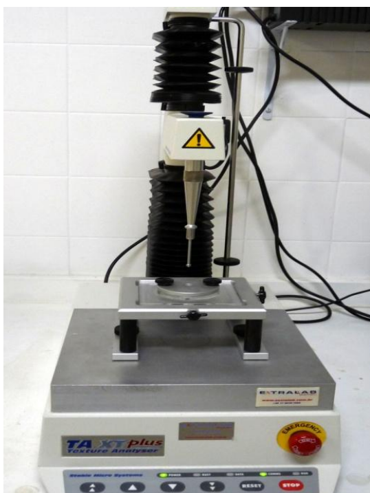
Figura 13a e 13b Analisador de textura Texture Analyzer TA XT Plus equipado com acoplamento utilizado nos testes de perfuração.
