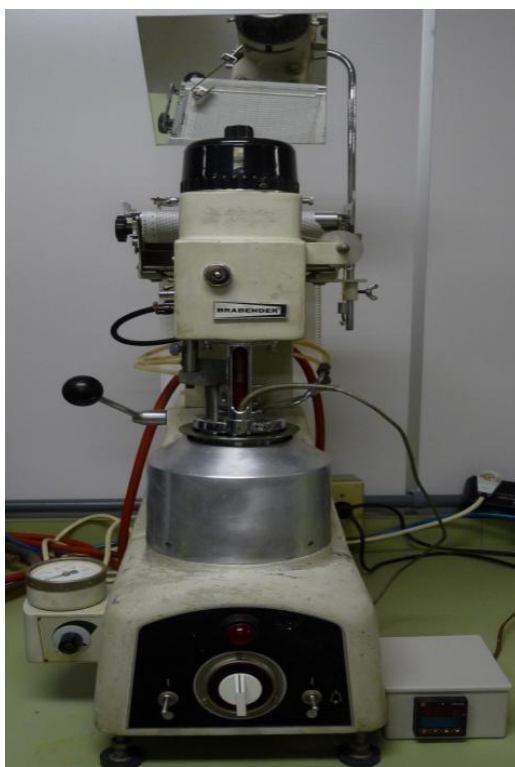
Figura 8 Viscoamilógrafo Brabender (Duisburg, Alemanha) usado no preparo da solução filmogênica.
