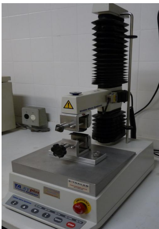
Figura 12a e 12b Analisador de textura Texture Analyser TA XT Plus (Surrey, Inglaterra) com acoplamento utilizado nos testes de tração.
