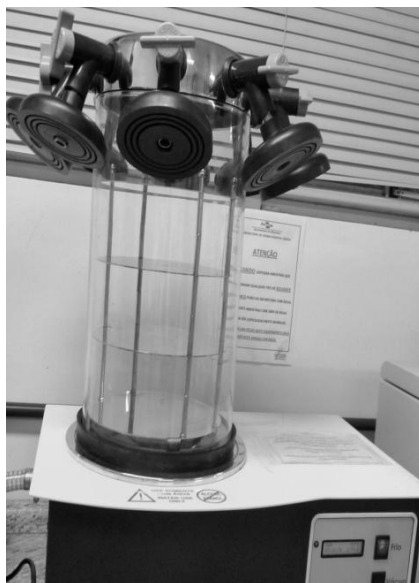
Figura 7a Liofilizador Liotop L101 (Liobras, São Carlos, Brasil)
