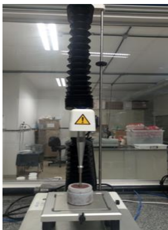
Figura 12. Equipamento utilizado para análise de textura do sorvete utilizando-se Texturômetro.
