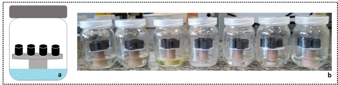
Figura 12: a) Desenho esquemático do recipiente hermético onde foram armazenadas as amostras para a construção de isothermas de sorção e b) Recipientes herméticos experimentais.
