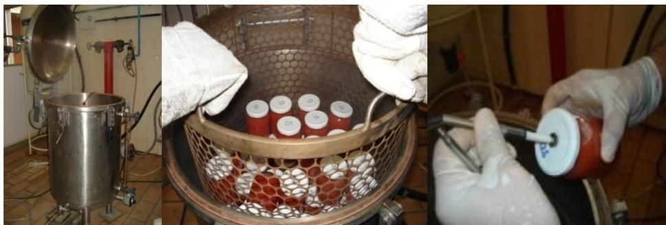
**Figura 16** – Autoclave e termopar utilizado para o tratamento térmico das polpas concentradas.
