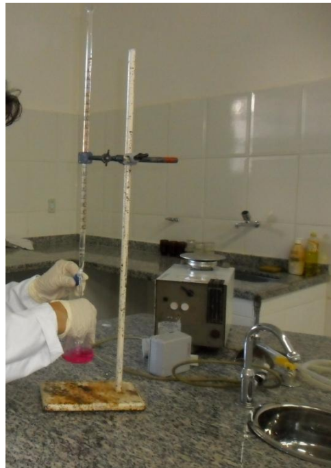
Figura 6. Determinação de acidez dos iogurtes
