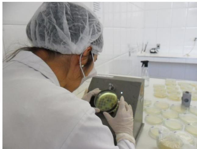
Figura 5. Contagem de colônias usando o contador de colônia Quebec.
