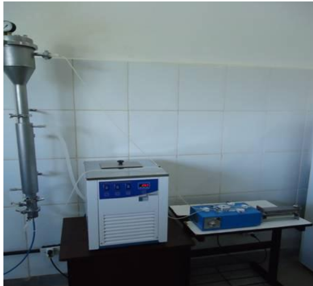
Figura 7: Foto do “air-lift” conectado às mangueiras em conjunto com a bomba peristáltica, passando por entre o par de ímãs nos ensaios com aplicação de campos magnéticos.
