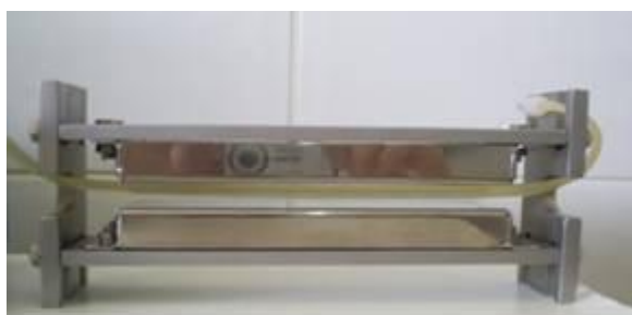
Figura 9: Magnetizador com par de ímãs para geração dos campos magnéticos.
