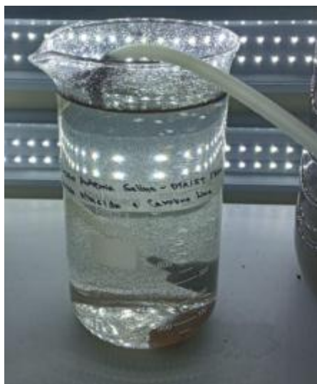
Figura 5: Ensaio com os cistos de Artemia salina L. ( Artemiidae ) (solução salina 3% p/v de cloreto de sódio em água mineral), em becker de 1000L.
