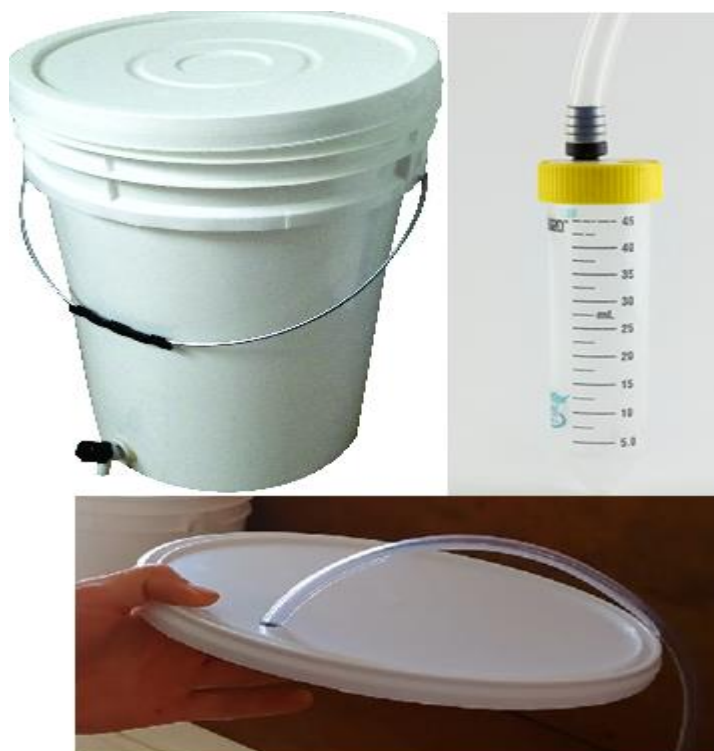
Figura 5 Recipiente utilizado para armazenamento do suco durante as 6h a 37 °C com mecanismo airlock adaptado.
