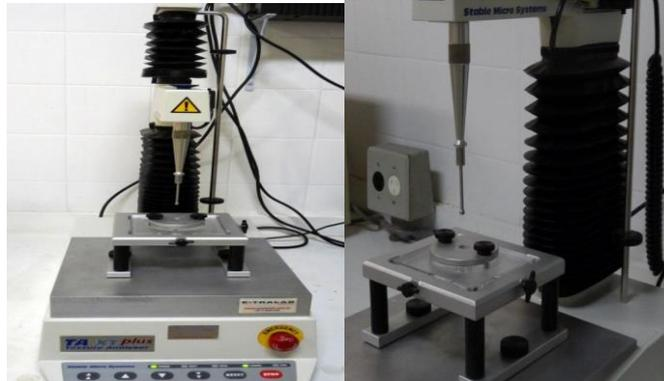
**Figura 22a e 22b.** Analisador de textura Texture Analyzer TA XT Plus equipado com acoplamento utilizado nos testes de perfuração.
