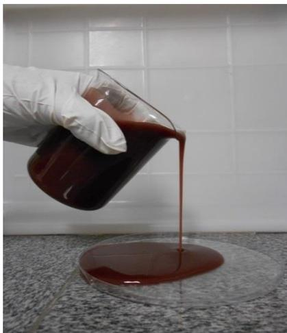
**Figura 18:** Solução filmogênica de amido, glicerol e açáí liofilizado sendo vertida em placa de petri *plexiglass*.
