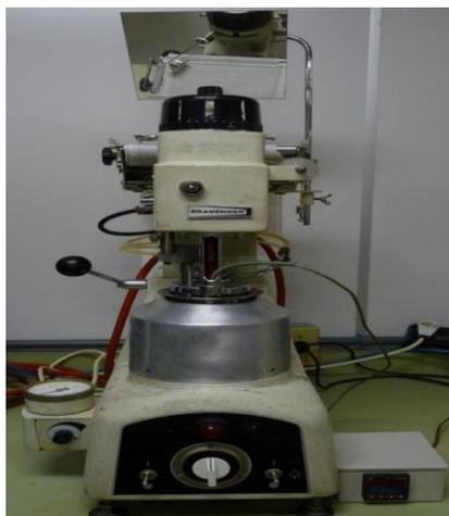
**Figura 17.** Viscoamilógrafo (Brabender, Duisburg, Alemanha) usado no preparo da solução filmogênica.
