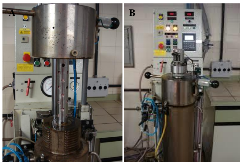
Figura 5- Equipamento de APH Stanted Fluid Power modelo S-FL-850-9-W, Inglaterra. (A) aberto (B) fechado. Fonte: LEAL (2010)
