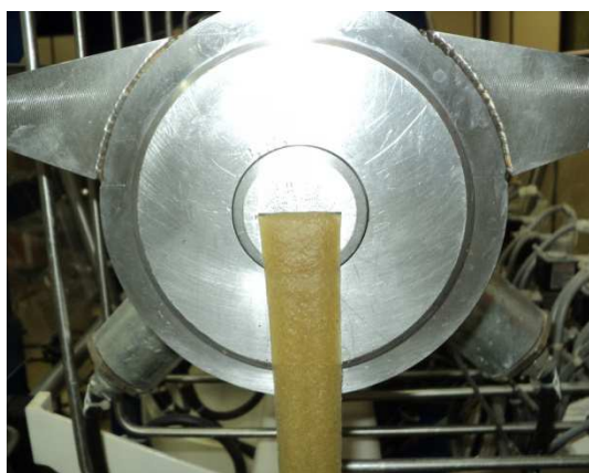
Figura 9. Material sendo extrudado pela matriz laminar da Extrusora Clextal Evolum HT25.
