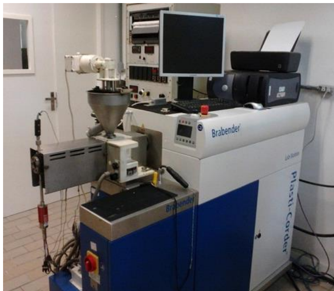
Figura 24. Extrusor de laboratório de parafuso único 19/20 DN (Brabender, Duisburg, Alemanha) acoplado em um reômetro de torque Plasti-Corder Lab Station (Brabender, Duisburg, Alemanha).
