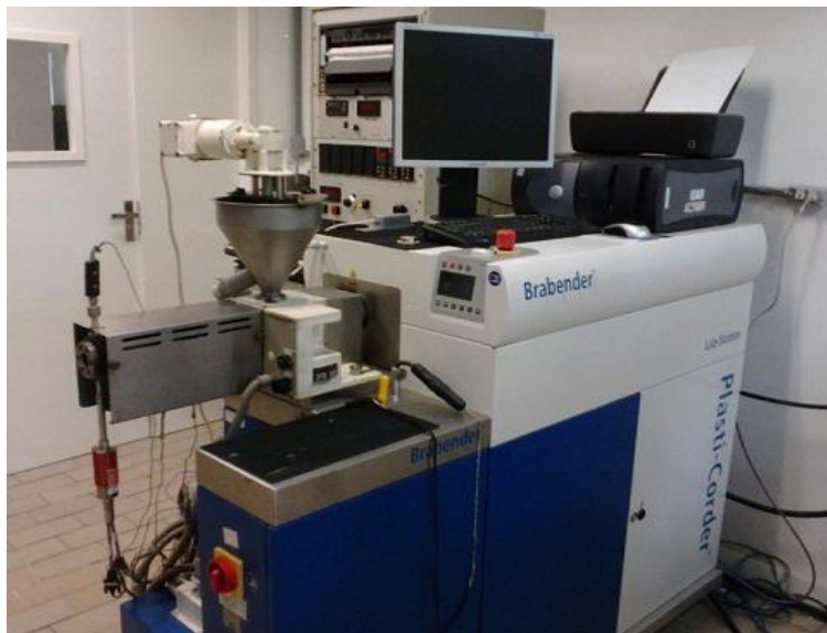
Figura 14. Extrusora de laboratório de parafuso único 19/20 DN (Brabender, Duisburg, Alemanha) acoplada em um reômetro de torque Plasti-CorderLabStation (Brabender, Duisburg, Alemanha).
