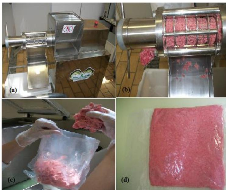
**Figura 6.** (a) e (b) equipamento CMS, (c) embalagem da CMS, (d) CMS embalada a vácuo.
