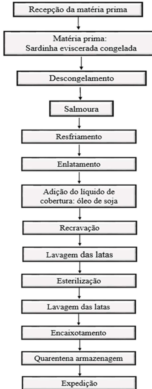
Figura 10: Fluxograma do processamento das sardinhas em conserva (Adaptado de COSTAMARINE, 2021).
