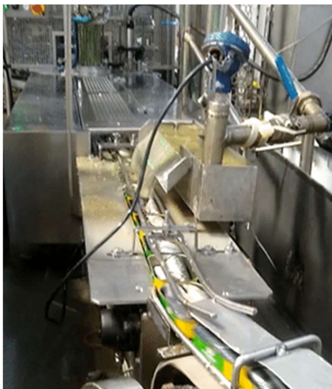
Figura 9: Adição do líquido de cobertura em óleo de soja às latas de sardinha.
