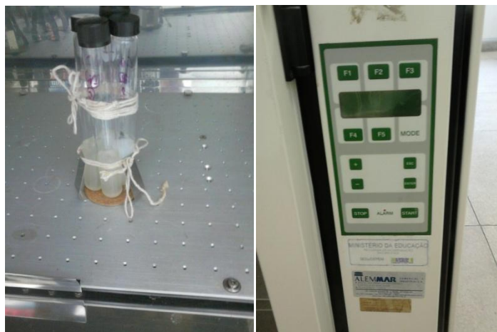
Figura 5: Agitação das células livres e encapsuladas em SGA em leve agitação no shaker
