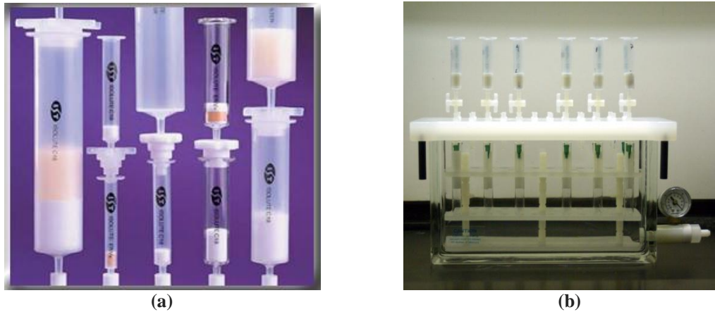
Figura 13: Imagem de: (a) cartuchos para SPE e (b) suporte para múltiplos cartuchos SPE para ser utilizado por aspiração a pressão reduzida.
