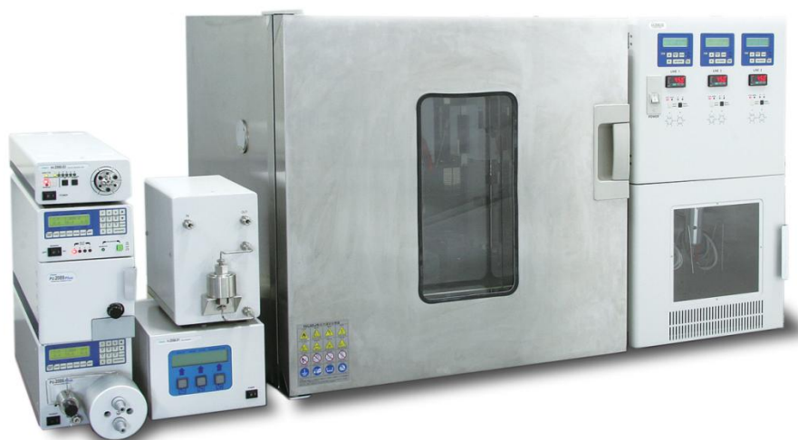
Figura 11: Imagens de um aparelho de extração por (SFE) preparativo.
