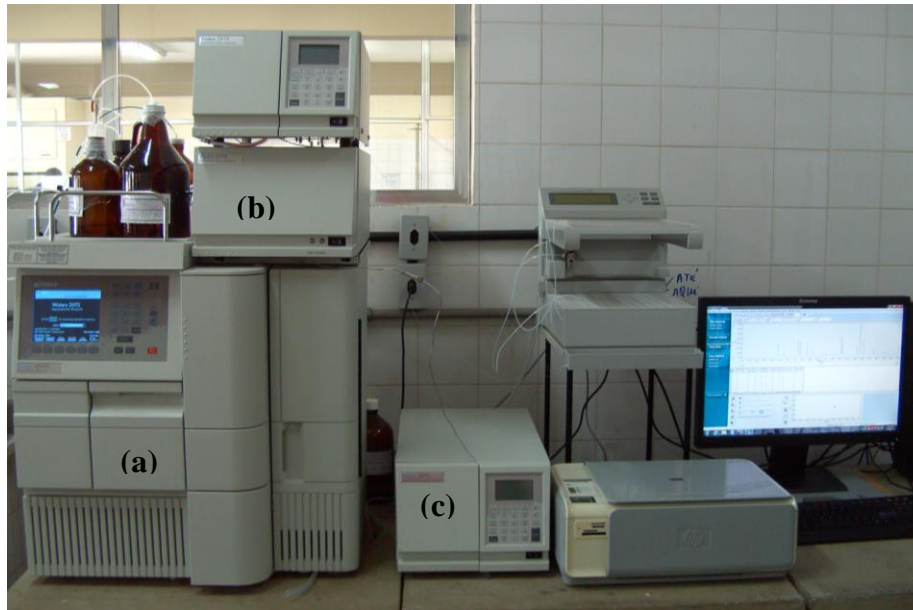
Figura 20: - Sistema cromatográfico constituído de : (a) Módulo de separação modelo Alliance e2695 - Waters ® . (b) Detector com arranjo de diodos modelo 2998 - Waters ® . (c) Detector de fluorescência de comprimento de onda variável modelo 2475 - Waters ® .
