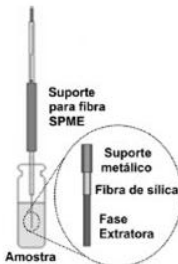
Figura 14: Esquema da microextração em fase sólida (SPME).
