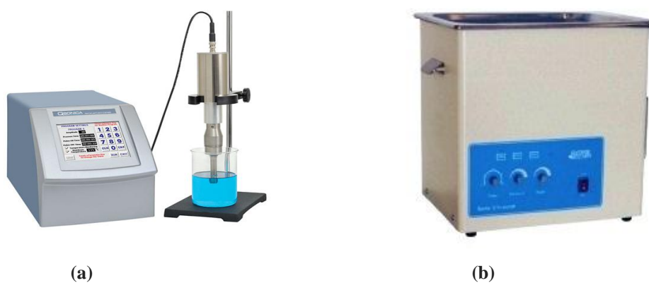
Figura 8: Imagens de (a) aparelho de ultrassom com sonda e (b) aparelho de ultrassom por imersão.
