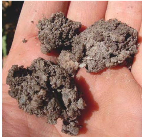
Figura 17: Agregação da areia pela argila, configurando solos permeáveis porém com capacidade de armazenamento de água.
