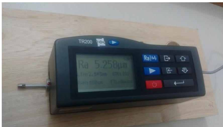
Figura 4 – Medição da rugosidade com o rugosímetro TR 200. Fonte: Próprio autor.
