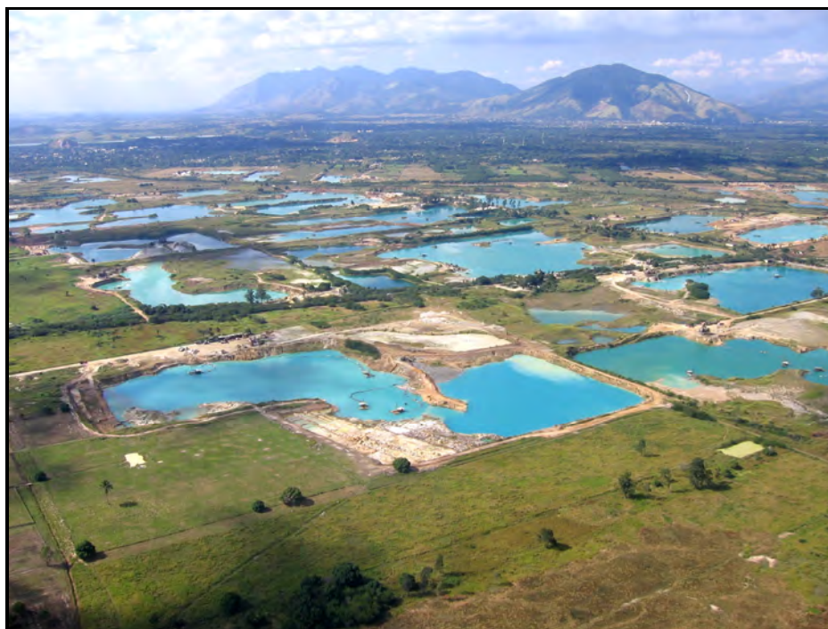
Figura 24. Lagoas formadas pela extração de areia no município de Seropédica, RJ, próxima ao leito do rio Guandu.
