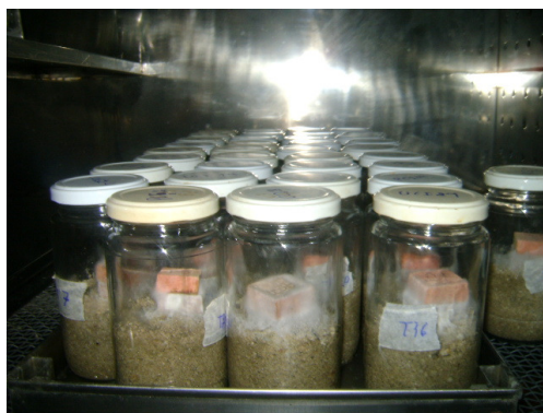
Figura 5 –Ensaio de durabilidade da madeira tratada conforme a ASTM D 1413 (1994).
