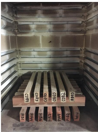
Figura 4. Disposição das lamelas no interior do forno para realização de tratamento térmico
