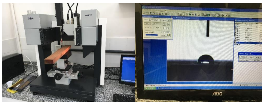
Figura 15. A: imagem de uma lamela sendo gotejada no equipamento DSA 100 Drop Shape Analyzer . B: imagem gerada no software do equipamento, onde é calculado o ângulo de contato da gota.
