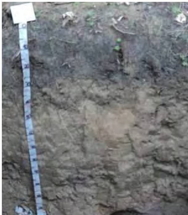
Figura 15: Perfil do Cambissolo Háptico Ta Eutrófico, encontrado na Área 3 da SFE – UTE Barbosa Lima Sobrinho, em Seropédica, RJ.
