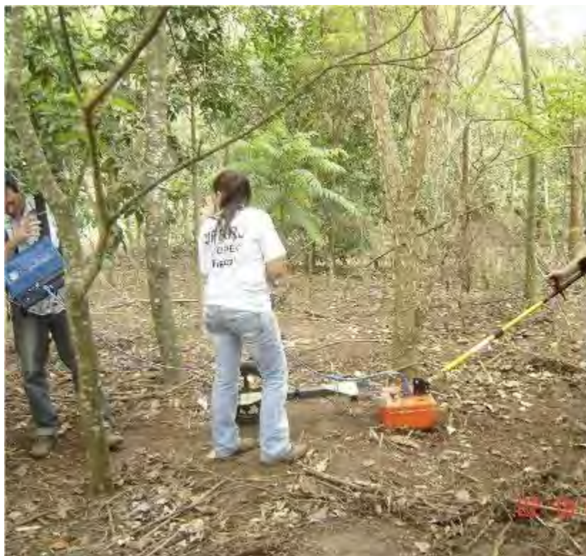
Figura 9: Utilização do GRP para leitura da profundidade do lençol freático na área de reflorestamento da UTE Barbosa Lima Sobrinho, em Seropédica, RJ.
