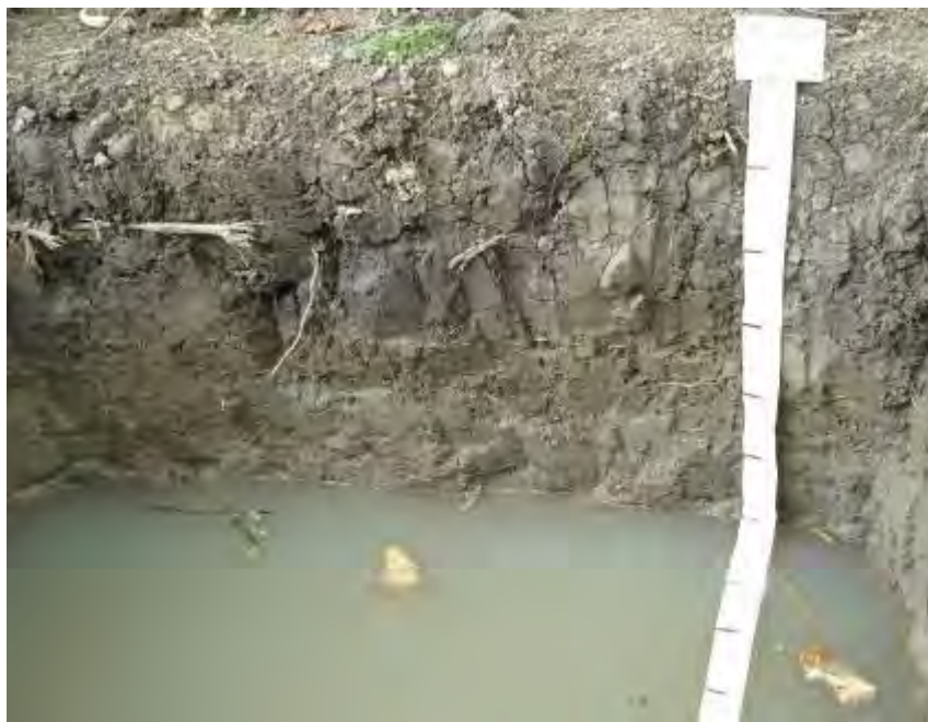
Figura 14: Perfil do Gleissolo Háptico Tb Distrófico neofluvíssólico, encontrado na Área 2 da UTE Barbosa Lima Sobrinho, em Seropédica, RJ.
