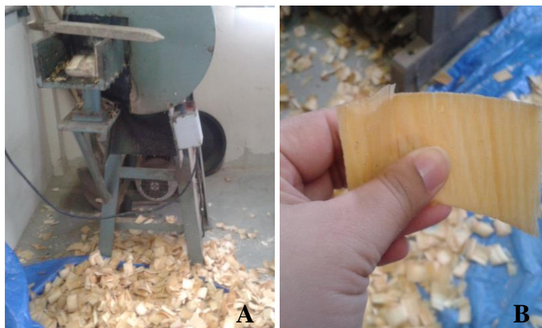
Figura 2. Gerador de partículas (A) e a partícula originada pelo mesmo (B).
