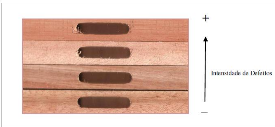
Figura 7 - Rasgos laterais produzidos com teste de rasgo com diferentes intensidades de defeitos.
