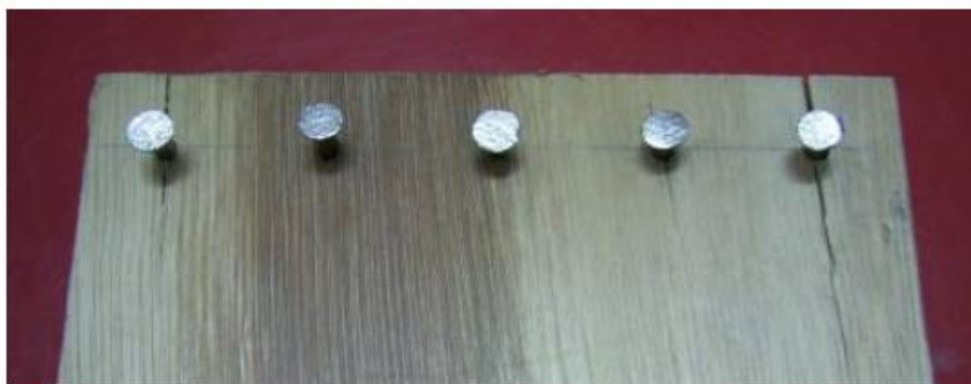
Figura 8 - Corpo de prova do teste de fendilhamento por prego demonstrando o aparecimento de trincas em parte das pregações.
