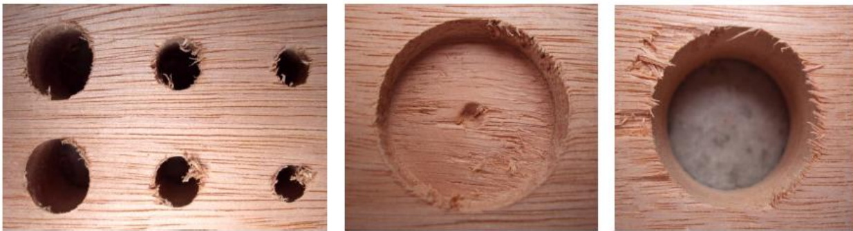
Figura 6 - Furações para cavilha representando médio arrancamento de grã a severa e furação não passante apresentando arrancamento nas bordas e esmagamento de grã e passante, com arrancamento severo de grã.
