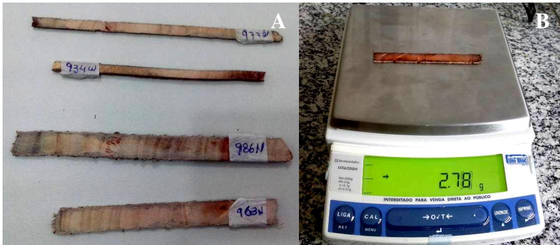
Figura 8. Determinação da densidade básica pelo método gravimétrico. (A) Amostras analisadas; (B) Amostras pesadas na balança digital.
