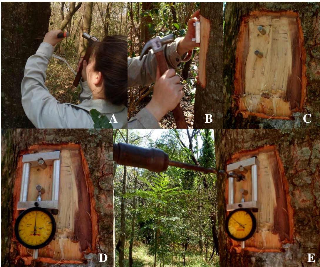
Figura 7. Mensuração da deformação residual longitudinal (DRL). (A) Retirada da casca; (B) Fixação pinos metálicos com gabarito; (C) Pinos metálicos fixados no lenho; (D) Extensômetro apoiado no pino metálico; (E) Liberação da tensão de crescimento através do orifício feito com o arco de pua.
