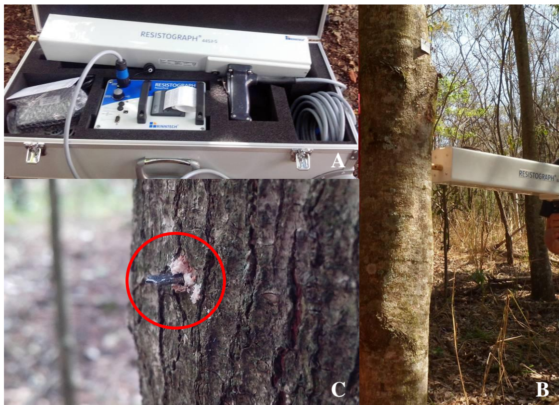
Figura 11. Mensuração da densidade através do resistógrafo. (A) Resistógrafo; (B) Mensuração da densidade em árvores vivas através do resistógrafo; (C) Perfuração realizada de casca a casca, broca atravessando o lenho.
