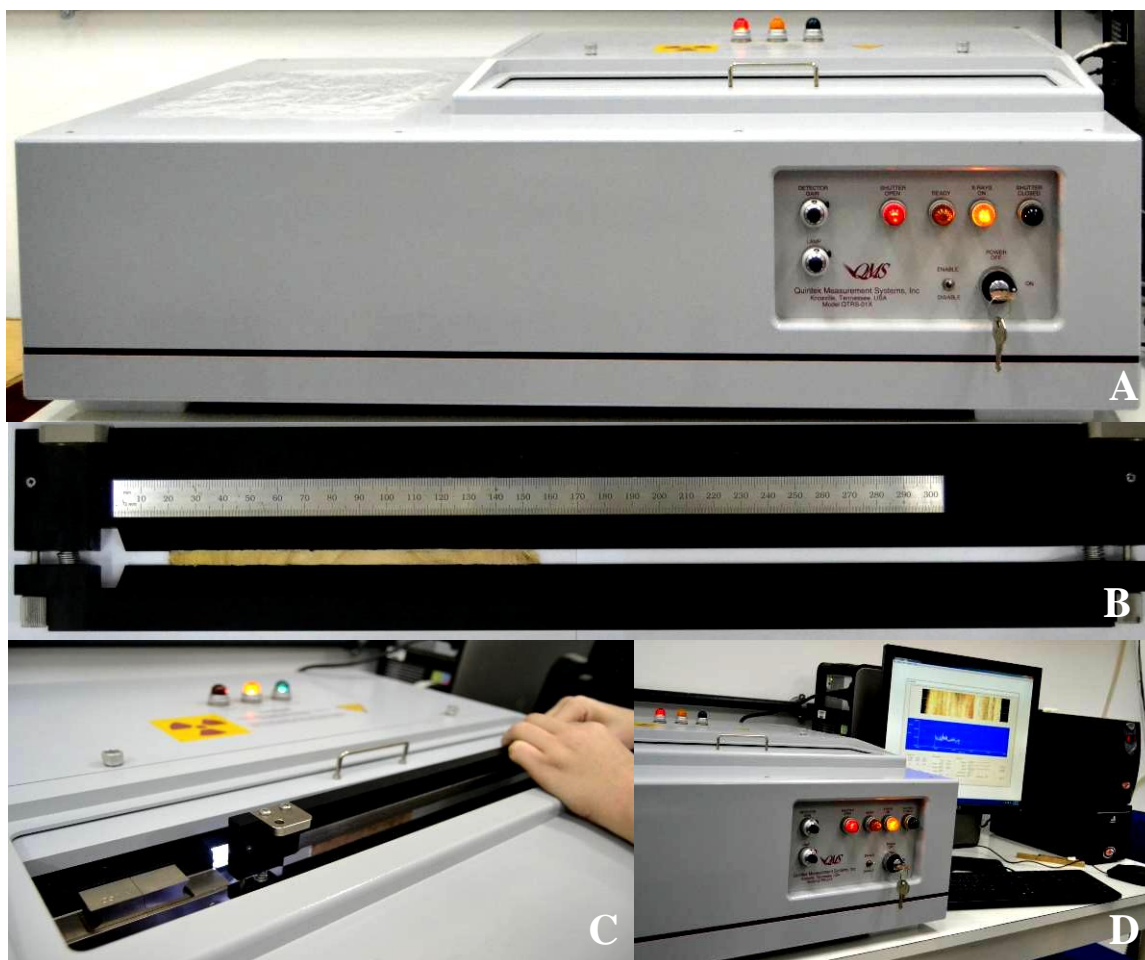
Figura 10. Determinação da densidade aparente através da densitometria de raios X. (A) Equipamento densitometria de raios X da Quintek Measurement Systems (QMS), modelo QTRS-01X; (B) Amostra no suporte metálico graduado; (C) Encaixe do suporte metálico com a amostra no compartimento interno; (D) Escaneamento da amostra e a visualização na tela do monitor do computador.
