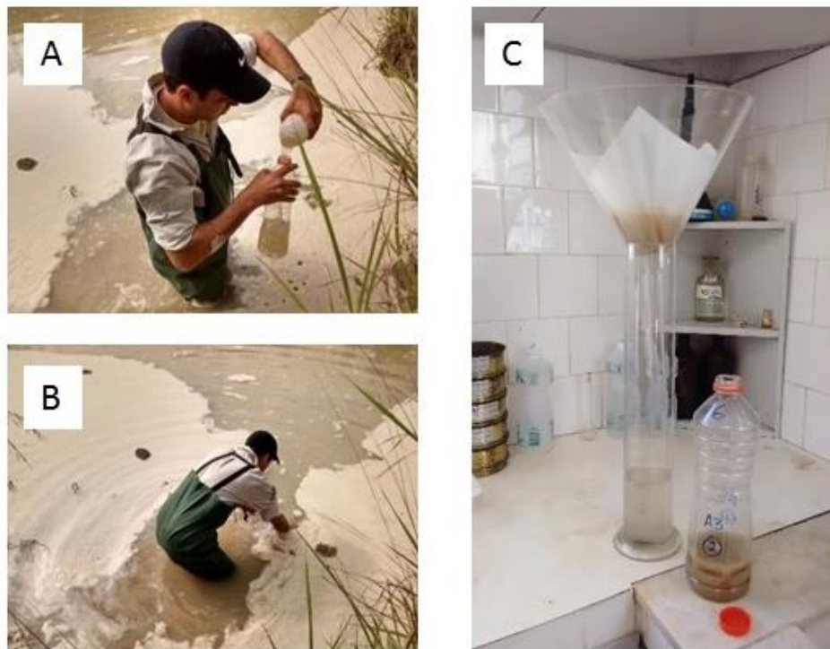
Figura 29 – Coleta de sedimentos finos e processamento das amostras em laboratório: (A) coleta do amostrador; (B) transferência do efluente para o transportador; e (C) filtração do efluente e separação do sedimento fino.
