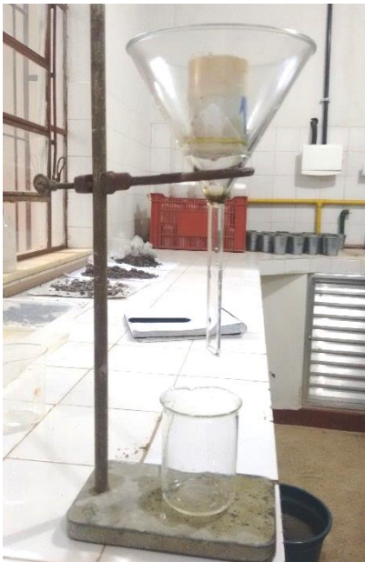
Figura 24 – Conjunto utilizado para determinação da condutividade hidráulica do solo.
