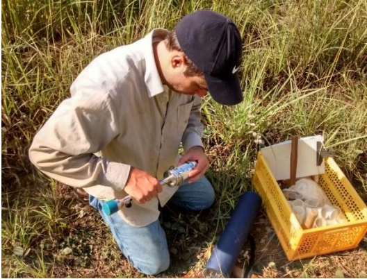
Figura 20 e 21 – montagem do trado de Uhland para coleta de amostra indeformada nos perfis de solo, em diferentes zonas hidrogenéticas.
