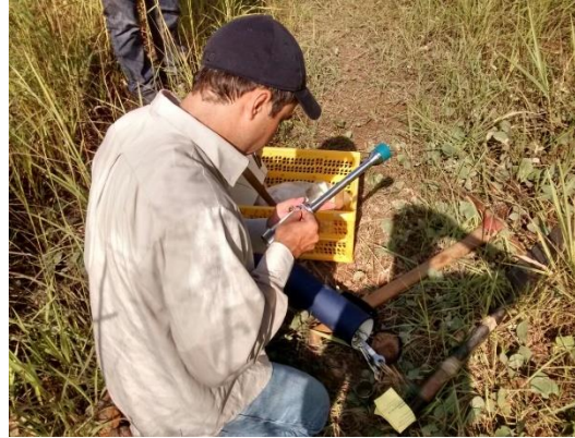
Figura 20 e 21 – montagem do trado de Uhland para coleta de amostra indeformada nos perfis de solo, em diferentes zonas hidrogenéticas.
