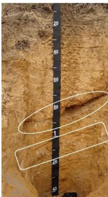
Figura 33 – Perfil de solo em cada zona hidrogenética, destaque para os pipes (destacado na primeira imagem com forma esférica) e camada de cascalho (destacado na primeira e segunda imagens com formas retangulares).
