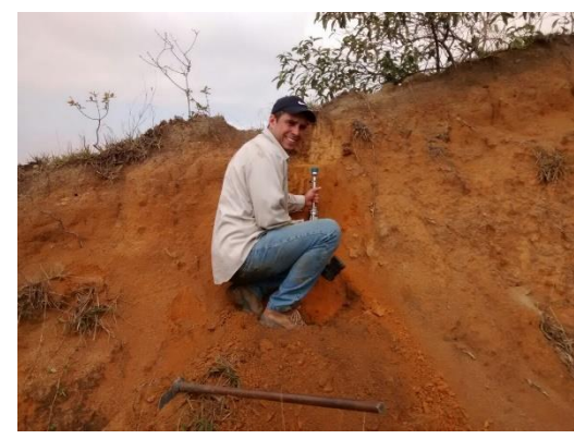
Figura 23 – Coleta de amostra indeformada com o trado de Uhland.
