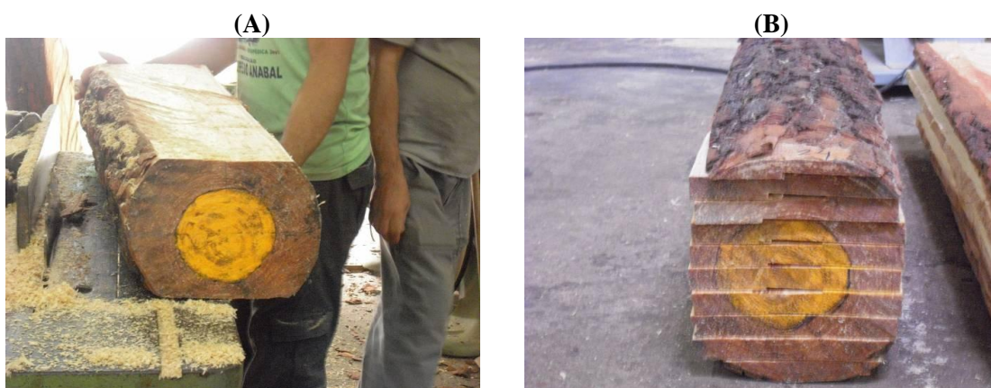
Figura 3: Desdobro das toras. (A). Tábuas com destaque para região central (amarela) e externa (sem cor), possibilitando identificar a região de procedência de cada uma delas (B).
