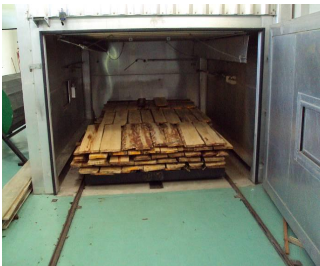
Figura 4: Estufa de secagem convencional do Laboratório de Física e Secagem da Madeira.
