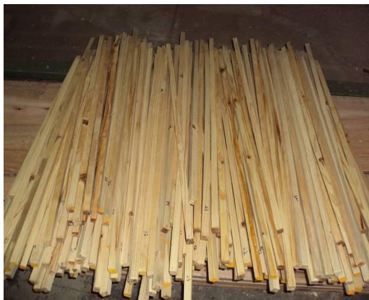
Figura 5: Sarrafos com 2 cm de largura, 2 cm de espessura e 1m de comprimento com as marcações que especificam procedência quanto árvore e região do lenho (central ou externa).
