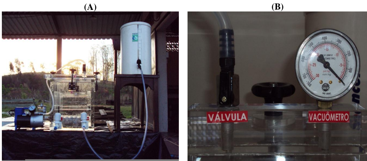
Figura 7: Dessecador adaptado com bomba de vácuo utilizado para realização do tratamento preservativo (A); detalhe para a válvula de liberação do vácuo e para o vacuômetro (B).
