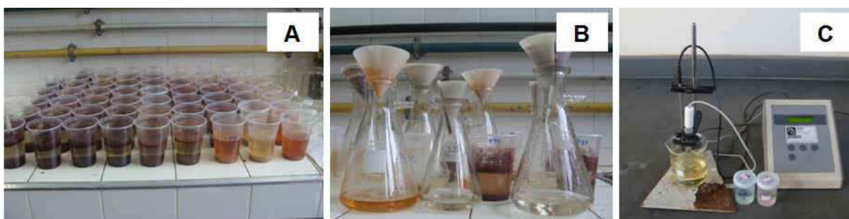
Figura 12. Procedimento utilizado para a determinação do pH das madeiras de Corymbia citriodora e Eucalyptus pellita não termorretificadas e termorretificadas.
