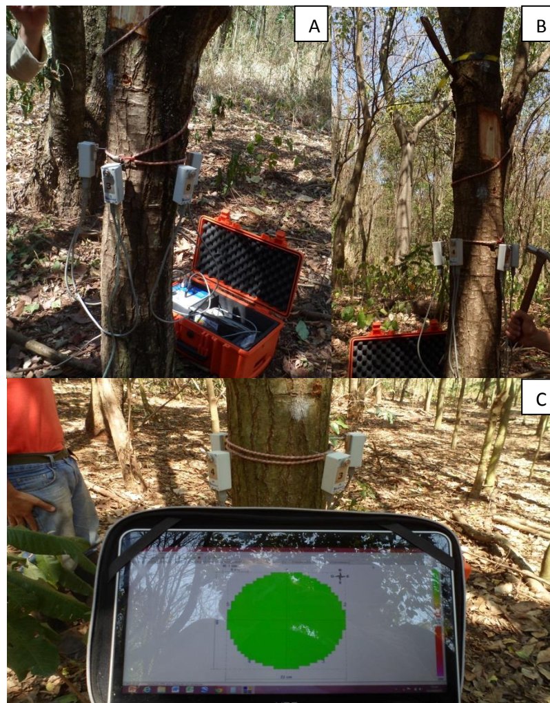
Figura 6. Realização da tomografia de impulso. (A) Instalação dos sensores; (B) geração de impulsos através do martelo; (C) imagem 2D representando o tronco de um indivíduo de Cedrela fissilis Vell.
