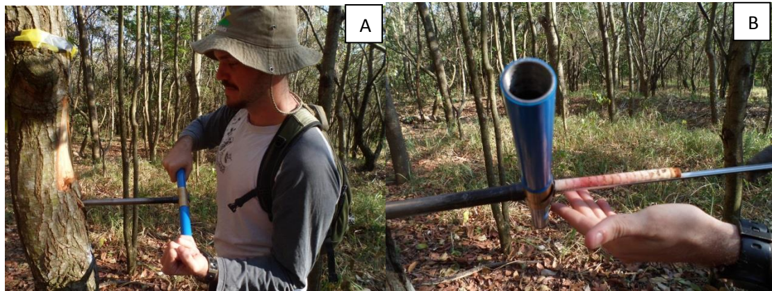
Figura 8. Retirada de baguetas através do trado de incremento de 12 mm de diâmetro. (A) Posicionamento e perfuração do trado no tronco; (B) retirada da bagueta.
