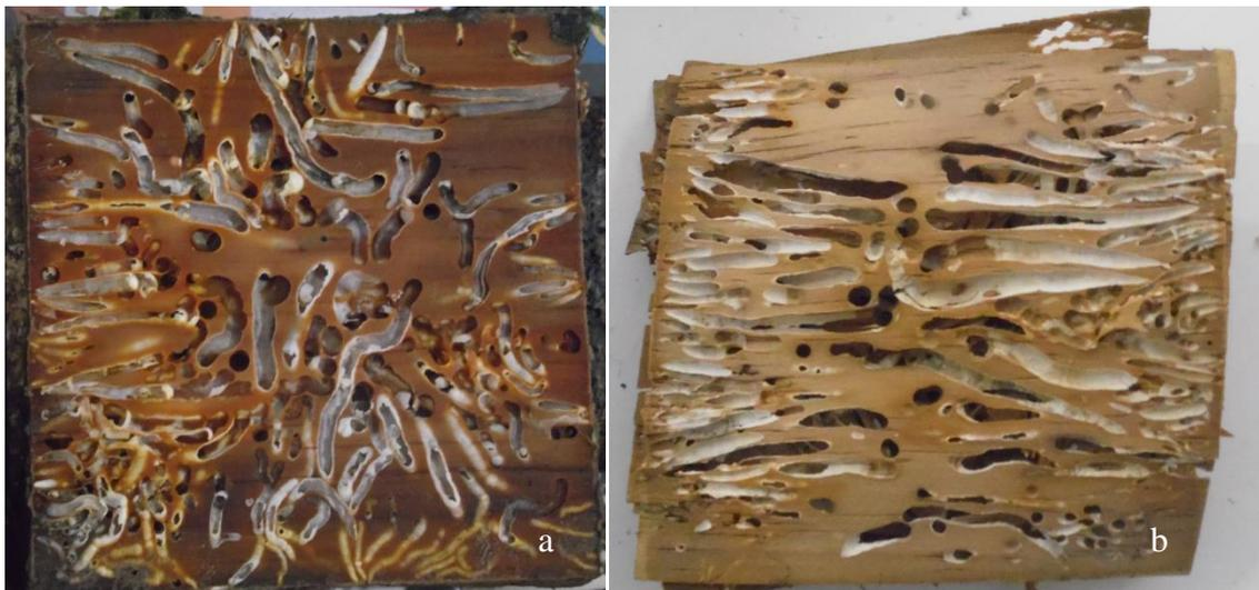
**Figura 13** – Infestação de teredos nas laminas de coletores: (a) valvas e estruturas calcárias podem ser observadas facilmente; (b) as galerias permanecem conservadas, mesmo após a retirada dos teredos e de seus componentes calcários.
