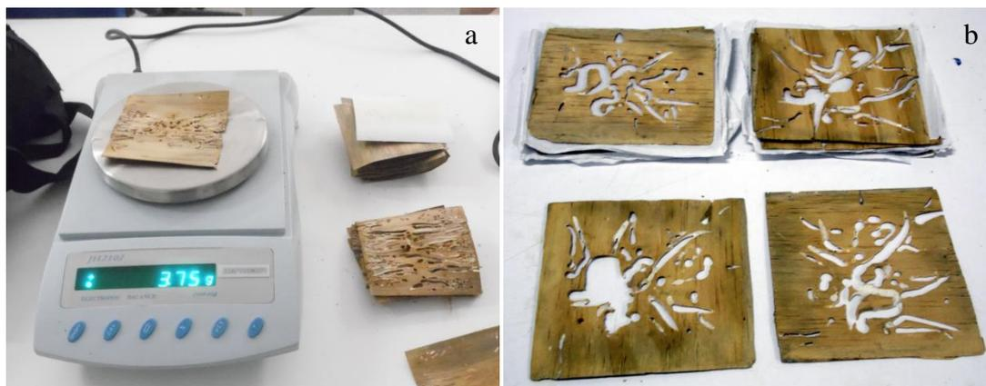
**Figura 15** – Representação da pesagem das laminas (a) e dos danos causados á elas pela atividade dos teredos (b).
