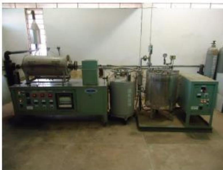
**Figura 5.** Forno com reator tubular de leito fixo, caldeira elétrica para o fornecimento de vapor d’água e recipiente “dewar” acoplado com  $N_2$ . Fonte: Bezerra (2012).
