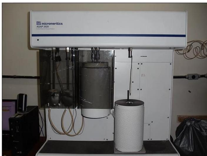
**Figura 6.** Microporosímetro ASAP 2020 utilizado para caracterização textural dos carvões ativado produzidos. Fonte: Acervo LCA.
