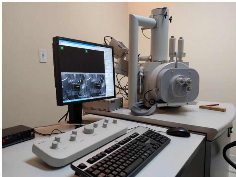
**Figura 7.** Microscópio eletrônico de varredura FEI Quanta 450 utilizado para a determinação da morfologia superficial dos carvões ativados produzidos.
