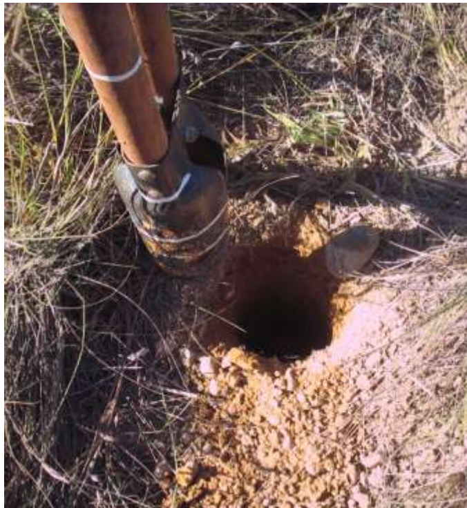
Figura 38. Coleta de solos deformados em diferentes profundidades em área de campo sujo na Estação Ecológica de Pirapitinga.
