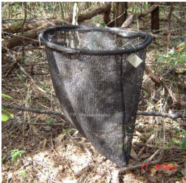
Figura 29. Coletor de serapilheira instalado em área de mata mesofítica na Estação Ecológica de Pirapitinga.
