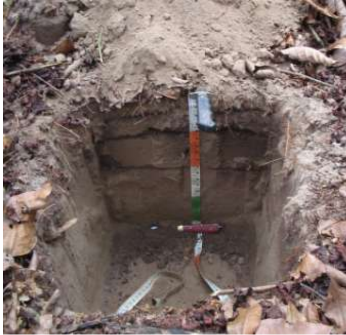
Figura 37. Exemplo de mini trincheira aberta para a coleta de amostras indeformadas na Estação Ecológica de Pirapitinga.
