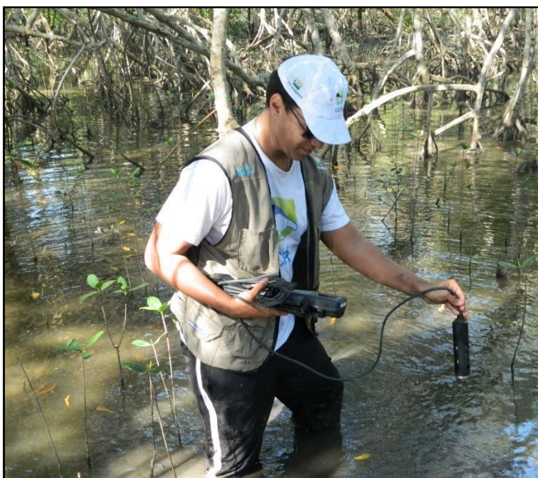
Figura 7: Obtenção da salinidade em campo (Imagem: Guilherme Rodrigues).
