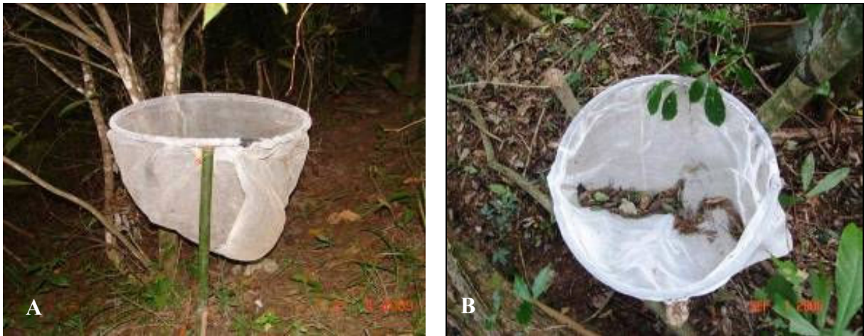
Figura 10. Coletor cônico utilizado para coleta da serapilheira, Pinheiral, RJ. A - Vista frontal do coletor cônico e B - Vista superior do coletor cônico.
