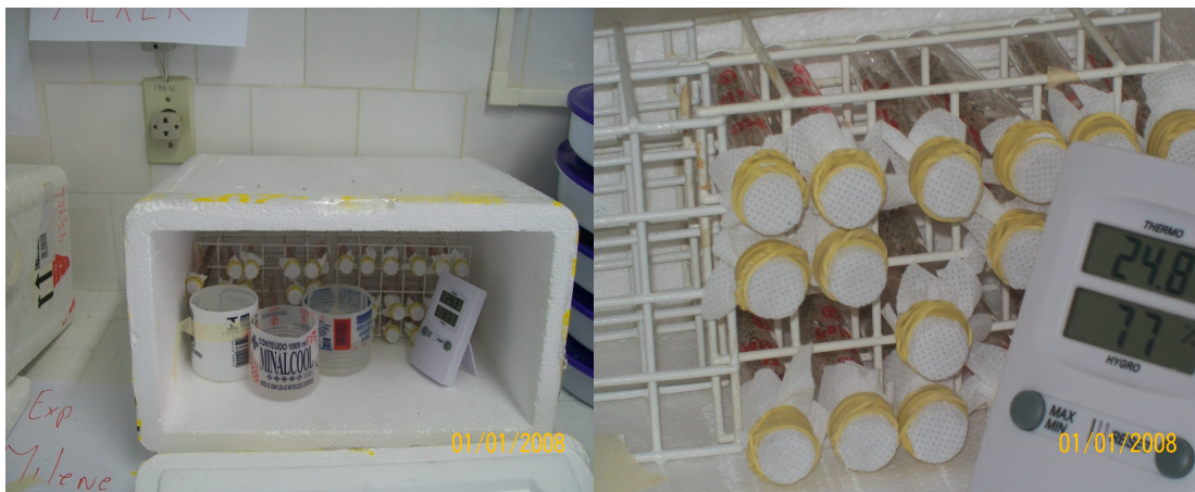
Figura 2. Caixas de isopor contendo os tubos de ensaio com 0,5 g da dieta selecionada, devidamente vedados com tecidos de náilon (TNT) e elásticos.
