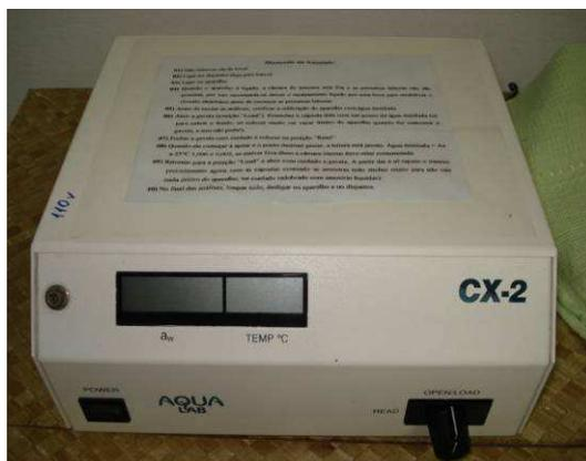
**Figura 10:** Equipamento AquaLab® modelo CX 2
