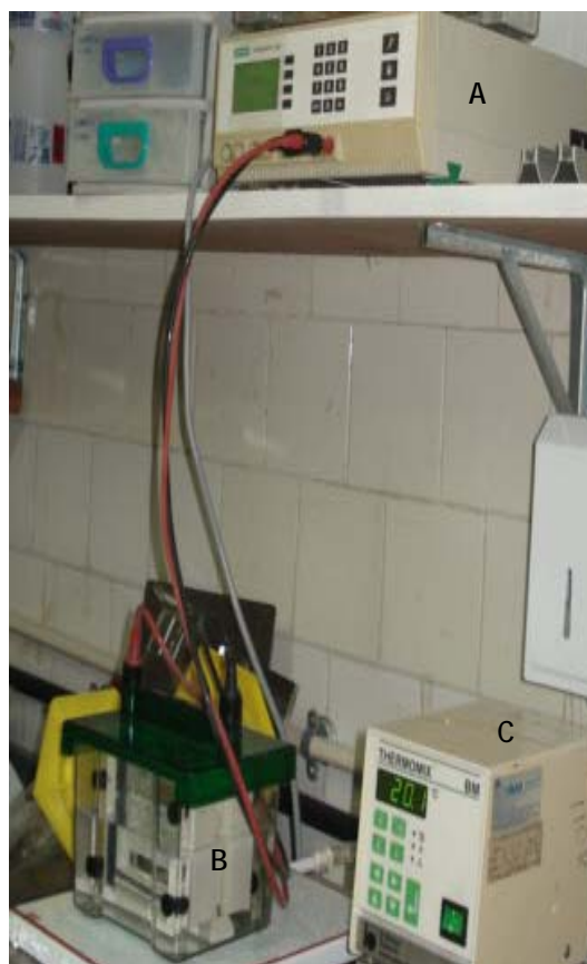
Figura 5. Sistema completo para realização da eletroforese descontínua em gel de poliacrilamida-SDS. Fonte geradora de corrente elétrica (A), Cuba para eletroforese (B) e Unidade de refrigeração (C).
