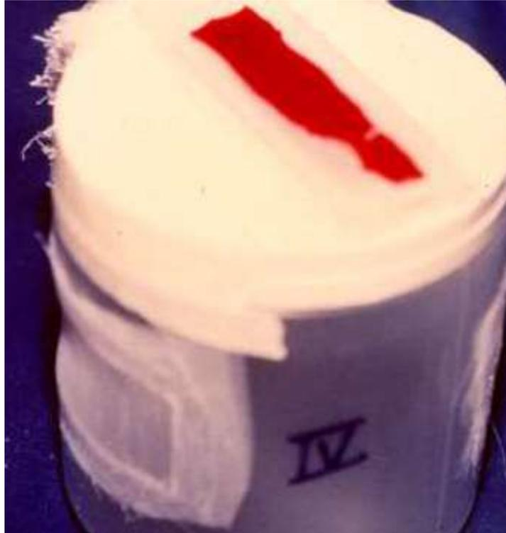
**Figura 4.** Gaiola de contenção com câmara de alimentação posicionada sobre o orifício do tampo.
