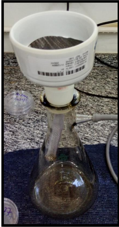
Figura 5: Funil de Buchner com filtro de papel preto, acoplado a um kitasato
