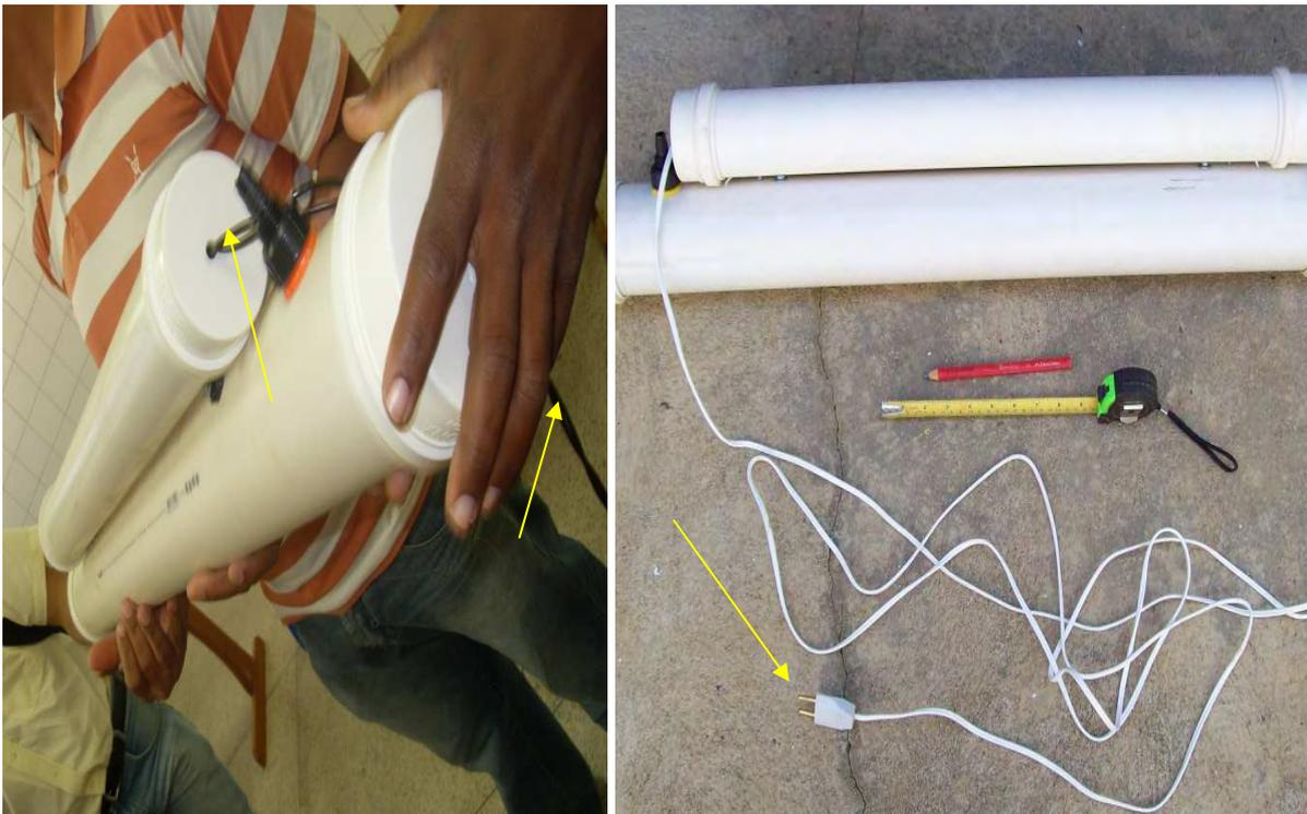
**Figura XIV** – Caps vedando um dos lados de cada um dos tubos e em destaque a passagem dos fios pelo caps do tubo de 75 mm Ø. À direita visualizamos a fiação condutora de energia, com plugue (macho), e o tubo de 100 mm Ø com a lâmpada já afixada pronta para conectar-se a rede elétrica de 220 V e conseqüente teste do sistema de elétrico do Tubo UV.
