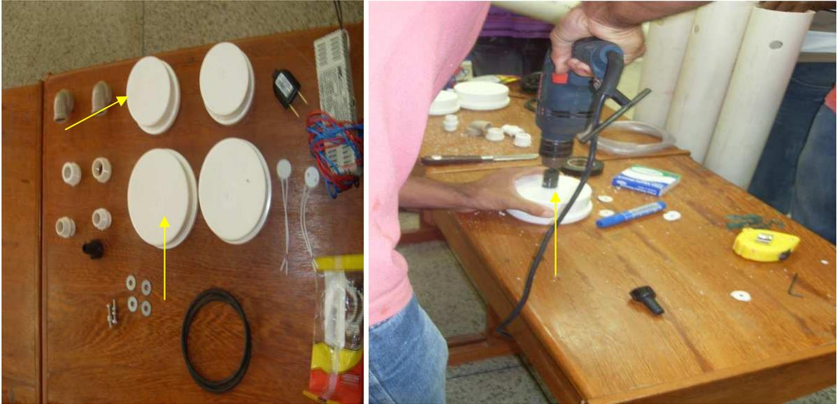
**Figura XIII** – Detalhe dos Caps de 100 mm Ø e 75 mm Ø e a direita a visualização da perfuração de um dos Caps de 75 mm Ø para passagem da fiação ligada ao reator permitindo a sua extensão aos fios condutores de energia elétrica.
