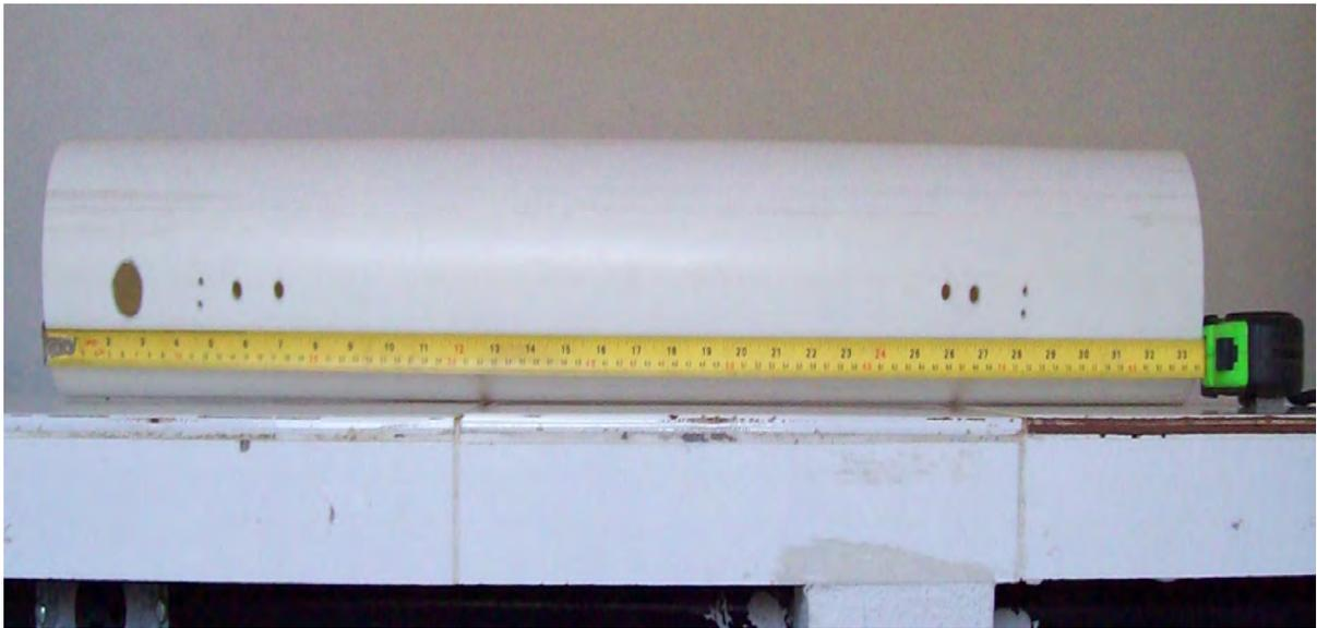
**Figura VII** – Detalhe do cano de 100 mm Ø e todas as perfurações necessárias para fixação dos equipamentos elétricos e do cano de 75 mm Ø, parte integrante do Tubo UV.
