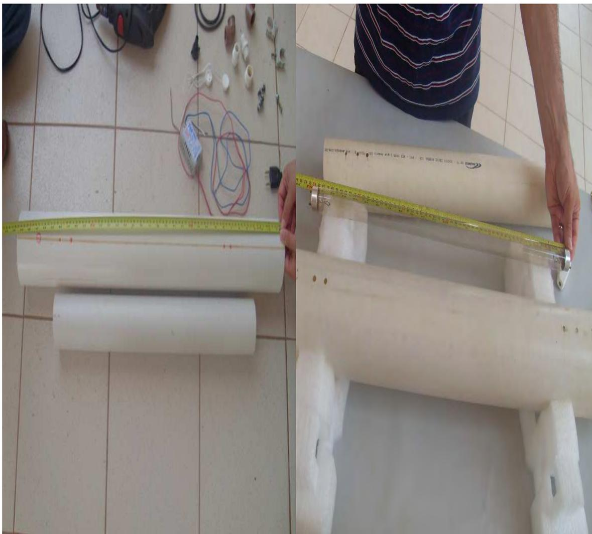
**Figura III** – Visualização dos tubos de 75 mm e 100 mm Ø conjuntamente com a lâmpada germicida, detalhe a direita, destacando-se o trabalho de marcação das aberturas responsáveis em fixarem os sistemas elétricos e hidráulico/germicida e seus respectivos materiais.
