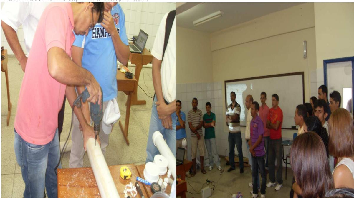
**Figura 36** – Imagens da 3ª Oficina de construção e adaptação do Tubo no momento em que um dos bolsistas, integrante da equipe de pesquisa realiza medição e perfuração dos orifícios necessários para junção do módulo receptor da lâmpada UV e do módulo receptor do reator usado para acionamento do equipamento. Ação realizada no Câmpus do Instituto Federal do Maranhão – Zé Doca, Maranhão, Brasil.
