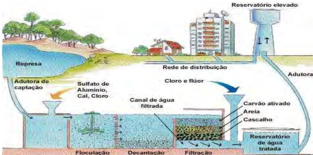
**Figura 01** – Ilustração das etapas de tratamento de água por cloração em uma Estação de Tratamento Água- ETA, demonstrando todo o caminho percorrido desde a fonte coletora, neste caso uma represa, até a rede de distribuição para edifícios e residências. **Fonte:** Coutinho (2009)
