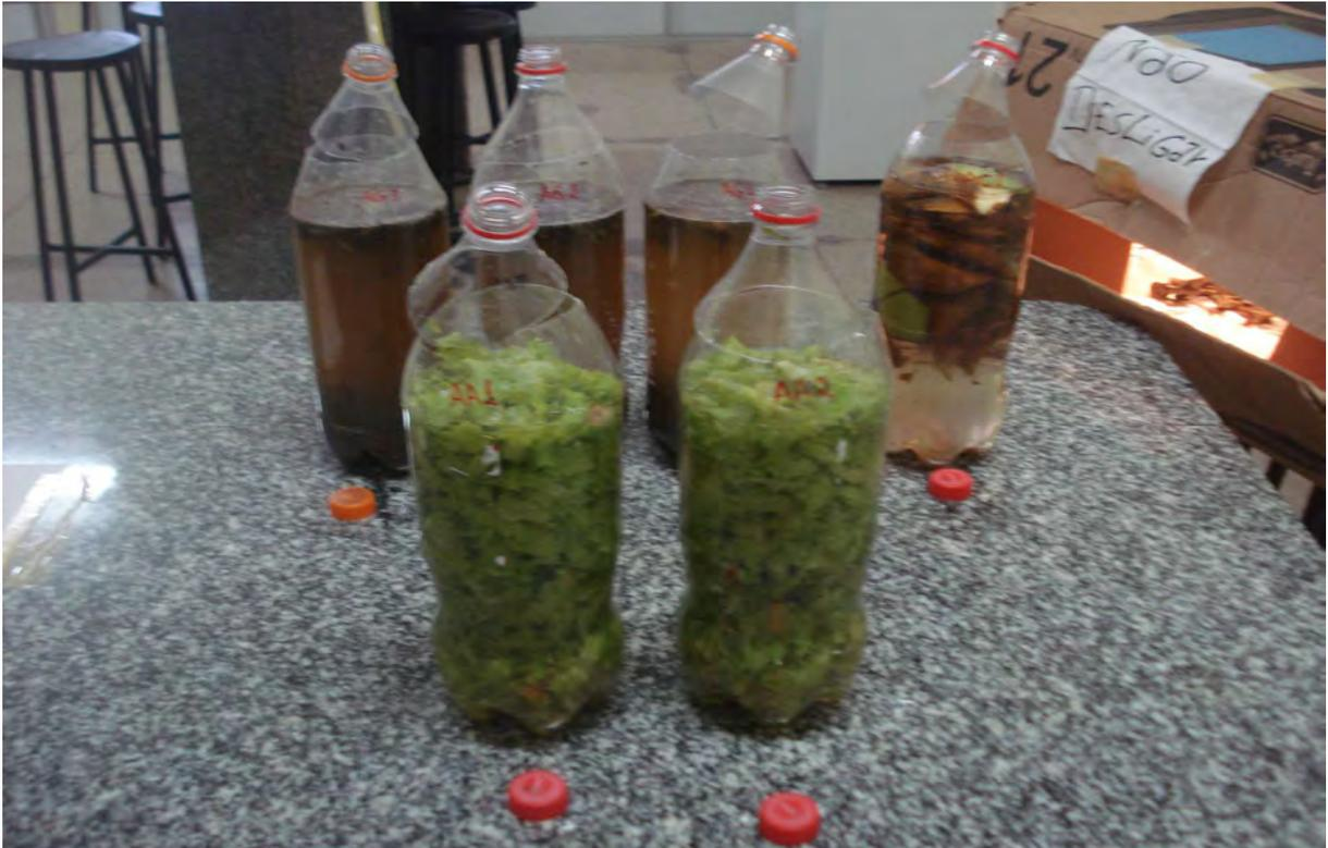
**Figura 30** – Imagens de garrafas de plástico com infusões a espera de sinais da produção de protozoários para teste, em laboratório do Câmpus Zé Doca-IFMA, de comprovação germicida do Tubo UV, Zé Doca, Maranhão, Brasil.
