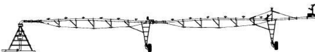
Figura 10: Esquema de uma vista lateral de um pivô central Fonte: Testezlaf
