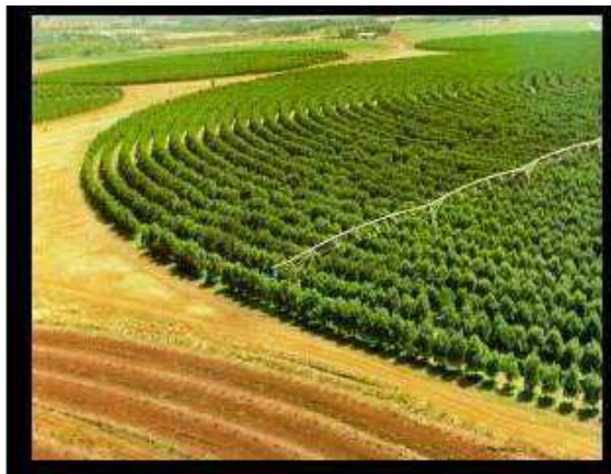
Figura 11: Sistema de irrigação do tipo pivô central implantado na cultura da laranja Fonte: Mantovani; Zinato; Simão
