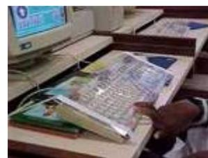
Teclado com Alteração na Inclinação e fixado à Mesa
