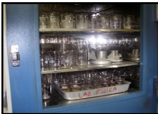
Figura 15: Estufa de laboratório de física do solo Fonte: Roberto Dias
