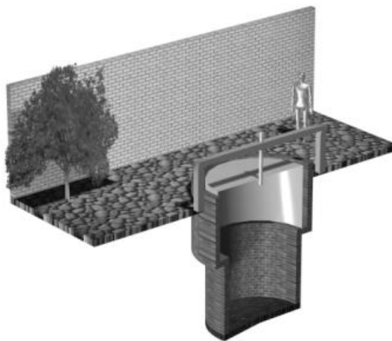
Figura 13: Representação tridimensional em corte do biodigestor modelo batelada. Fonte: DEGANUTTI ET AL., 2002
